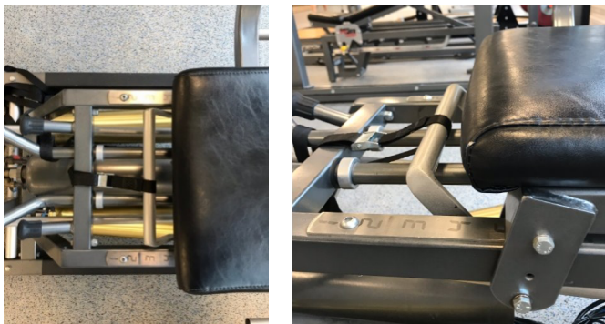
Bilde 2 Viktig at seteposisjonen stilles inn slik at lårbenet blir tilnærmet loddrett og at posisjonen blir registrert, det tallet som syntes ovenfra er riktig innstilling (på bildene er setet stilt inn på 4)
